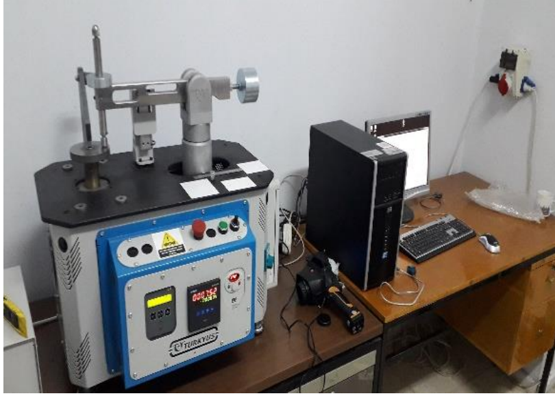
Şekil 5. Aşınma test düzeneği
