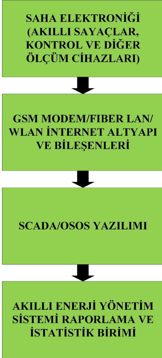
Şekil 4. Karaman OSB'nin akıllı enerji yönetim sistemi blok diyagramı.
