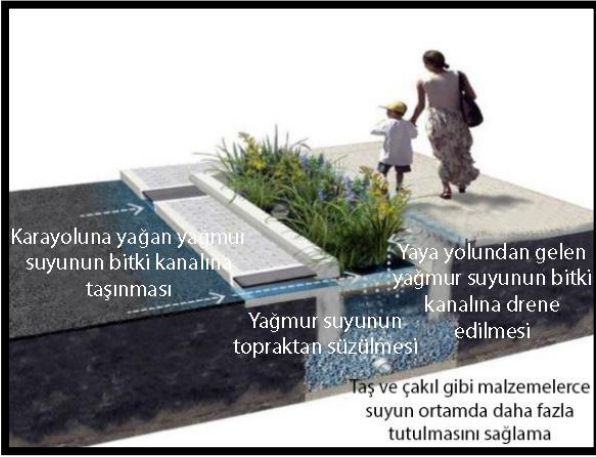
Şekil 4.3 Yüzeysel akışı sağlayan bioswale uygulaması (Kavuran 2021)
