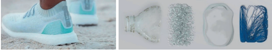
Görsel 2. Geri dönüştürülmüş plastik atık kullanımlı adidas x Parley ürettiği ayakkabı (parley.tv/updates) ve plastik atığın yüksek dayanımlı polyester ipliğe dönüşüm sürecini ifade eder görsel (adidas.com.tr).
