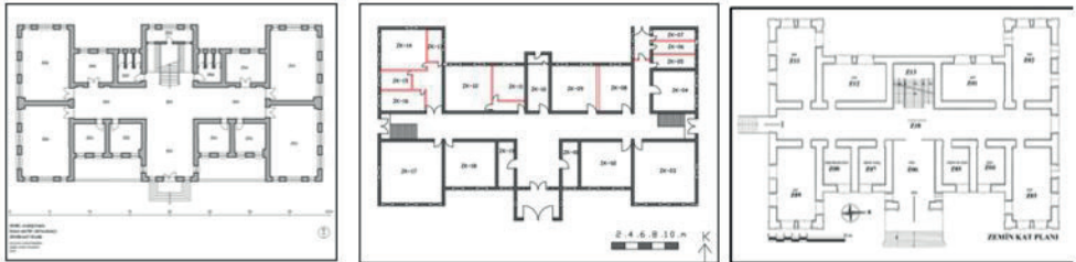
Görsel 101: 1910-1930 arası "E" şeması ile inşa edilmiş eğitim yapıları planları. Soldan sağa; İzmir Darülmuallimat Binası (Özel, "Tanzimat'tan Cumhuriyet'e İzmir'de Eğitim Yapıları", 284), Manisa Gazi Mektebi (Aydoğdu, "Manisa'da Cumhuriyet Dönemi Eğitim Yapıları (1923-1950)", 34) ve Malatya Gazi İlkokulu (Çelemoğlu, Atıcı, "Erken Cumhuriyet Dönemi İlkokul Yapılarına Bir Örnek", 133).
