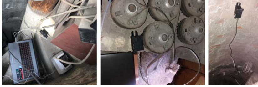
Şekil 9. Tek ve iki ivmeölçerin yerleşim düzenleri (Layouts of single and two accelerometers)
