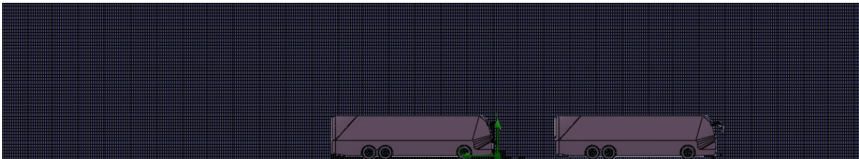
Şekil 2. Sayısal modellemedeki ağ yapısı görseli
