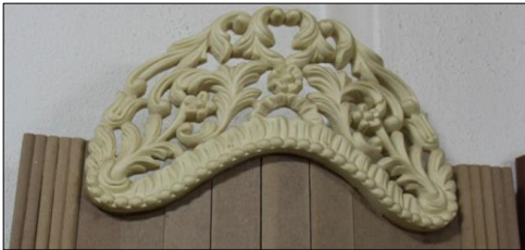
Resim 16. Poliüretan döküm ile üretilmiş oyma mobilya tepeliği (Carved furniture top made of polyurethane casting)
