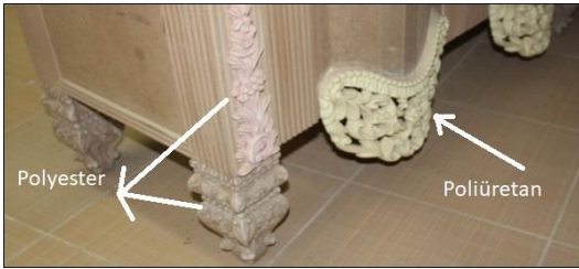
Resim 11. MDF levha ile üretilmiş konsolun polyester ve poliüretan döküm oyması (Polyester and polyurethane casting carving of console produced with MDF board)
