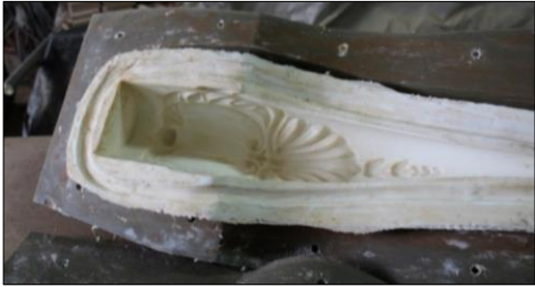
Resim 6. Silikon ile beyaz kalıbın alınması (A white version of a style table leg)
