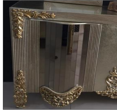
Resim 22. Polyester döküm uygulanarak üretilmiş klasik bir konsola yapıştırılan aplikler ve kapak altı apliğinden detay (Detail from appliques and under-the-hood appliques attached to a classic console produced by applying polyester casting)
