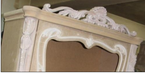
Resim 14. MDF levha ile üretilmiş çift kapaklı büfeye yapıştırılan polyester dökümler (Polyester castings attached to the double-door buffet produced with MDF board)
