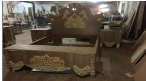
Resim 13. MDF levha ile üretilmiş karyola başlığı, ayakucu ve komodine yapıştırılan poliüretan dökümler (Polyurethane castings made of MDF board and glued to the headboard, footboard and nightstand)
