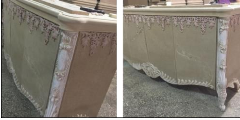
Resim 15. MDF levha ile üretilmiş konsola yapıştırılan polyester dökümler (Polyester castings attached to the console produced with MDF board)
