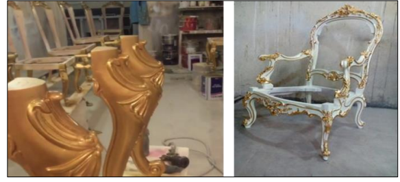
Resim 21. Poliüretan döküm ile üretilmiş klasik masa ayağı ve klasik koltuk (Classic table leg and classic armchair made of polyurethane casting)
