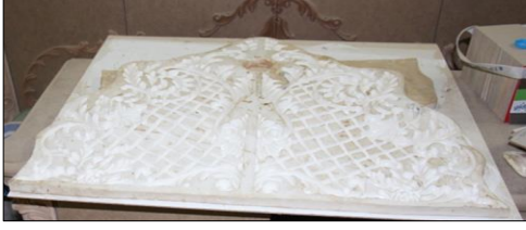
Resim 9. Yüzey oyma motifinin silikon beyaz kalıbı (Silicone white mold of surface engraving motif)
