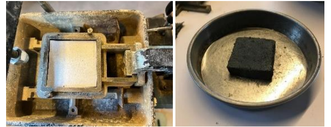
Şekil 4. Direk kesme kutusu deneyi
