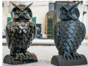
Şekil 6. Aseton buharıyla parlatılmış ABS numunenin önce (sağ) ve sonraki (sol) görünümü (Sunay ve ark., 2021)
