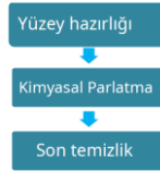
Şekil 5. Kimyasal temizleme işleminin genel akış şeması (Sunay ve ark., 2021)
