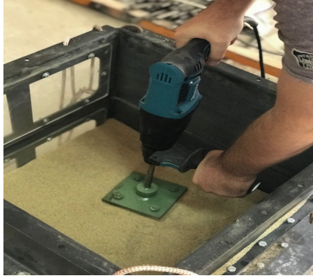
Şekil 7 - Kohezyonsuz Zemini İstenilen Rölatif Sıklığa Getirmek için Titreşim Cihazı
