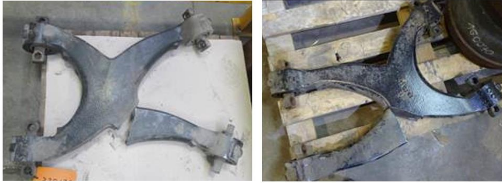
Şekil 2. Mevcut X-kol yapısında görülen kırılma durumları (Fracture states seen in the existing X-arm structure)
