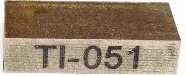
Şekil 3. Ti-6Al-4V iş parçası (5x10x20 mm) (Workpiece of Ti-6Al-4V(5x10x20mm))
