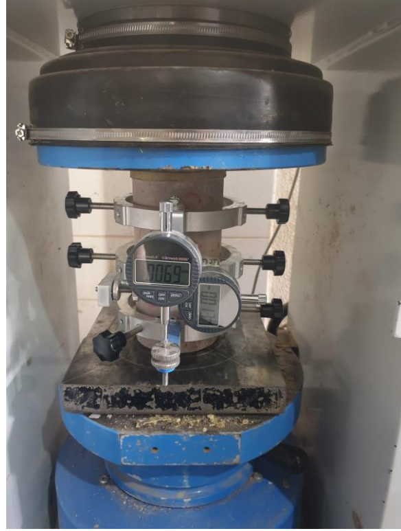
Şekil 1. Elastisite modülü deneyi
