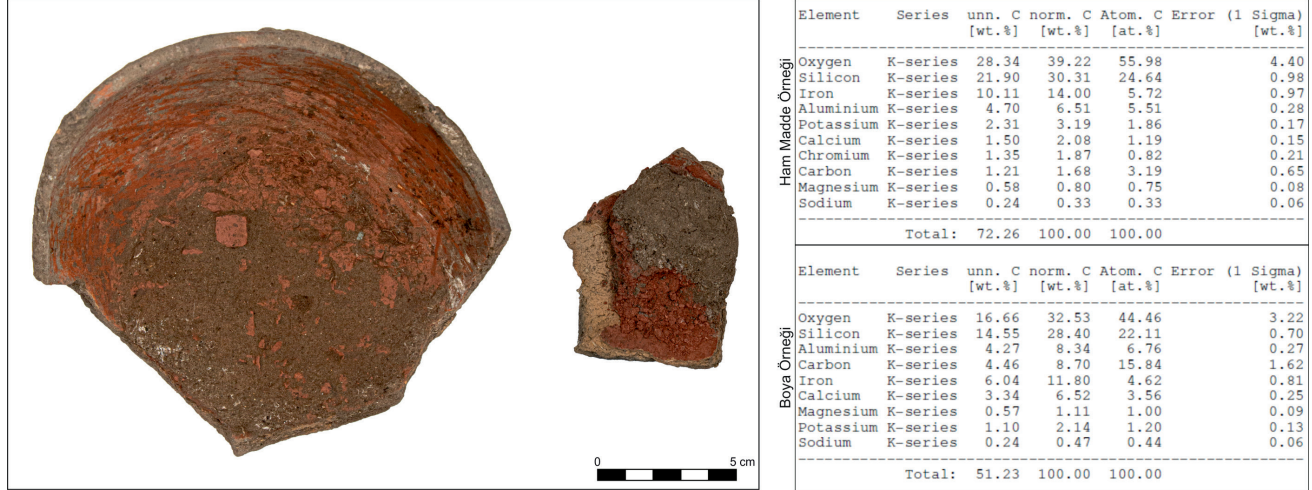
Figür 4. Hammadde Kalıntısı ve SEM-EDX Analiz Sonucu. / Raw Material Residue and SEM-EDX Analysis Result.
