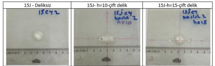
Şekil 5. 15J darbe enerjisine maruz deliksiz ve çift delikli cam elyaf takviyeli örgü numunelerin fotoğrafları
