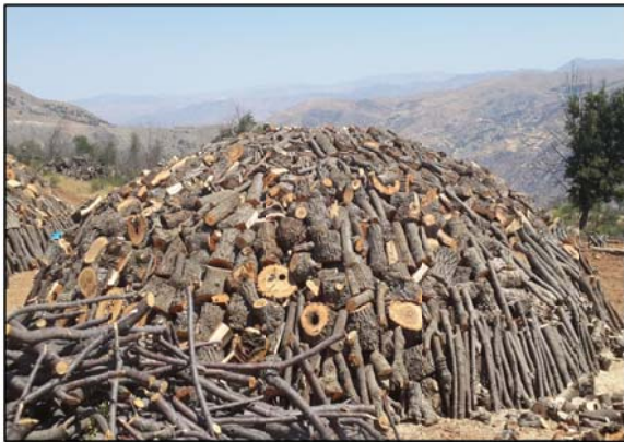
Şekil 2. Dik Torluklarda Parabolit Şeklinde İstifleme ve Toprak Örtüsü ile Kaplama.
