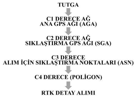
Şekil 4. TUTGA sistemine bağlı C derece nokta sıklaştırması
