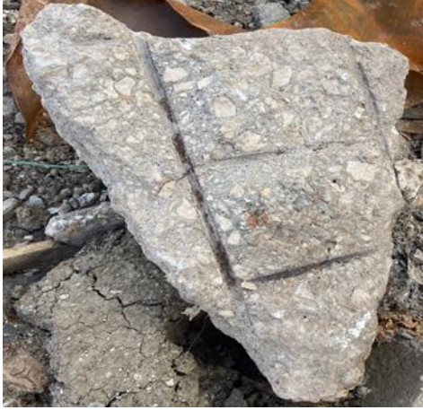
Şekil 6. Nervürsüz donatı kullanılan yapılarda deprem sırasında donatının betondan sıyrılması
