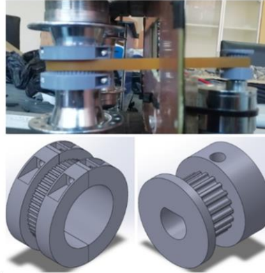
Şekil 4. Araçın güç aktarımı için tasarlanan dişli mekanizması
