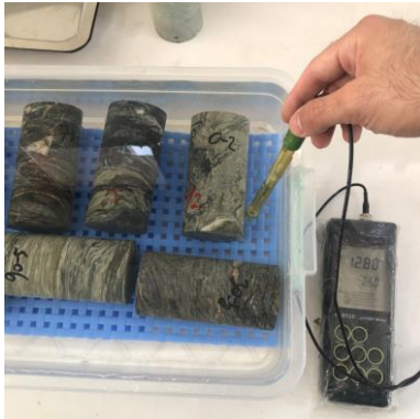
Şekil 7. Sıvı koşullarında pH kontrolü
