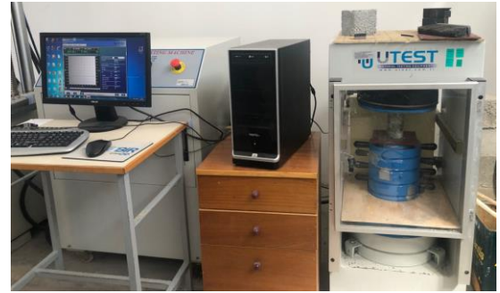
Şekil 4. Tek eksenli sıkışma dayanımı test düzeni
