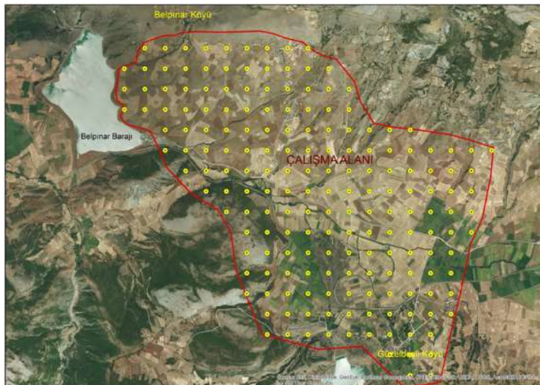
Şekil 5. Çalışma alanında dağılım gösteren yüzey toprak örnekleme deseni
