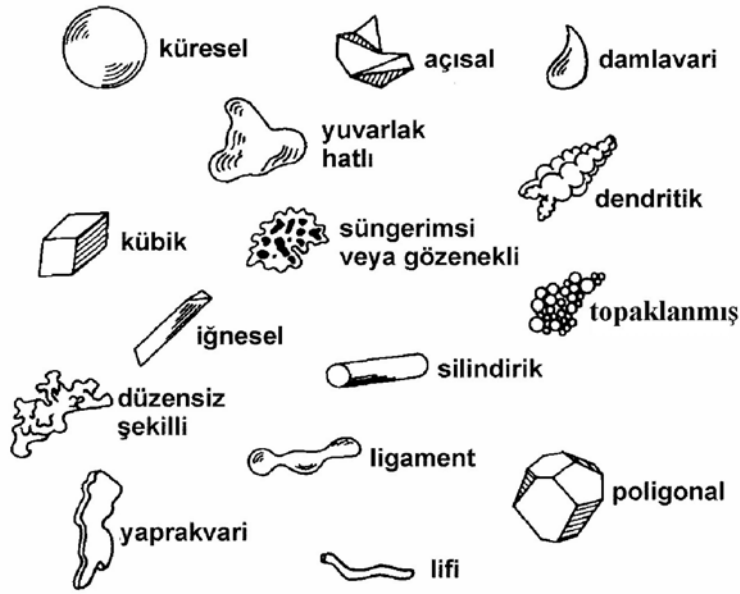
Şekil 2. Çeşitli üretim teknikleri ile üretilmiş toz şekilleri [3].
