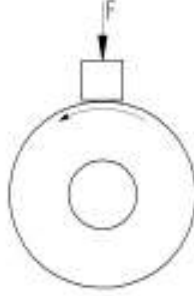
Şekil 7. Aşınma modeli şematik şekli.
