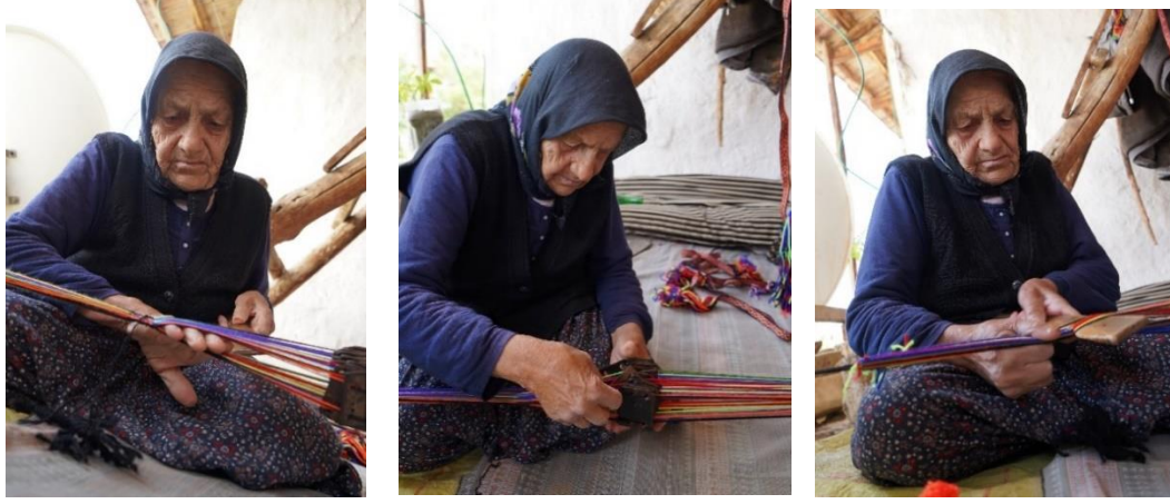
Fotoğraf 12-13-14. Çarpına dokuma işlemi, Kartları döndürme ve kılıç ile sıkıştırma işlemi, Dokuyucu Sümbül Çarkacı, Körküler köyü, Fotoğraf: Emine Turan Koşucu, 2022, Yalvaç-Isparta.
