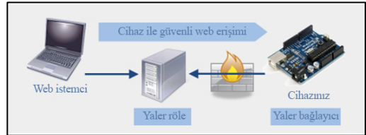
Şekil-3: Yaler ile gömülü cihaz arasındaki iletişim
