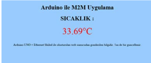
Şekil-4: Elde edilen sıcaklık verisinin web üzerinden izlenmesi
