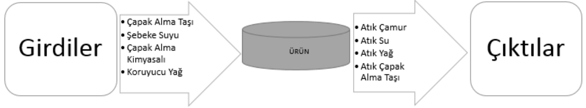
Şekil 2. Dönel çanakta yüzey bitirme süreci girdileri ve çıktıları
