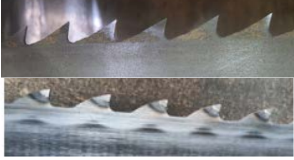
Şekil 4. Testere diş profilleri (Sol: Mevcut - KV diş profilli testere, Sağ: Önerilen – PU diş profilli testere).
