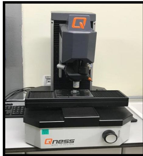
Şekil 4. Vickers Sertlik Test Cihazı
