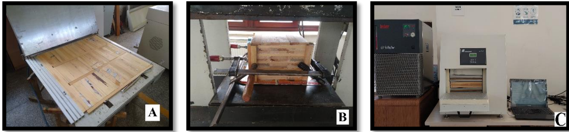
Şekil 2. Yan yana ekleme pres makinesi (A), Pres (B), Isı iletkenlik katsayısı tespit cihazı (C)
