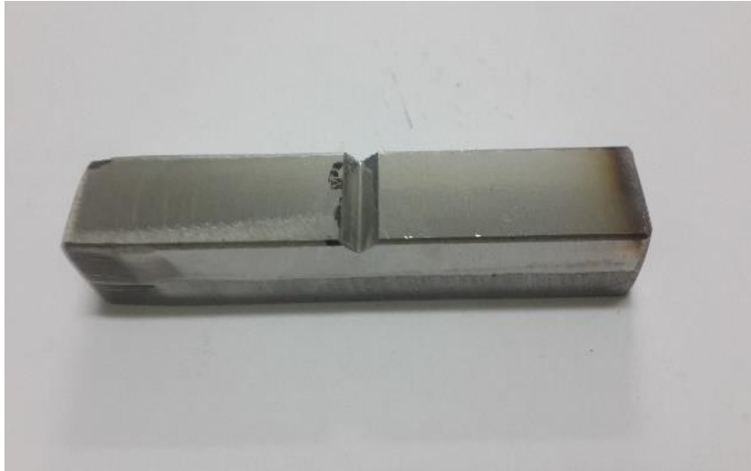
Şekil 2. Charpy darbe test numunesi
