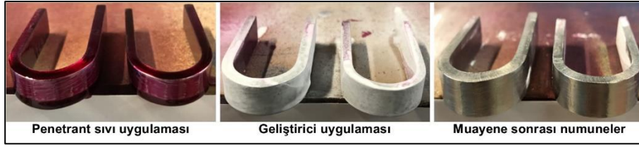
Şekil 6. Sıvı penetrant muayenesi uygulanan eğme numuneleri.
