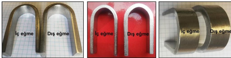
Şekil 5. Farklı açılardan eğme test numuneleri.
