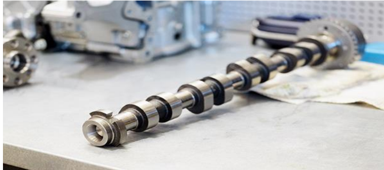
Şekil 2. Eksantrik mili (Eksantrik mili de motor ile bağlantılı olarak işlem yapan bir araç içi parçadır. Araç içlerinde yer alan supapların gerekli zamanda açılıp kapanmasını sağlayan ve üzerinde kam bulunan küresel demir ya da çelik alaşımdan yapılan bir sistemdir) [18].
