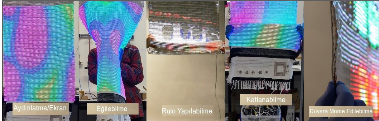
Şekil 5: Elektronik tekstil; aydınlatma/ekran- eğilebilme-rulo yapılabilme-katlanabilme-duvara monte edilebilme özellikleri (Choi, vd., 2022).
