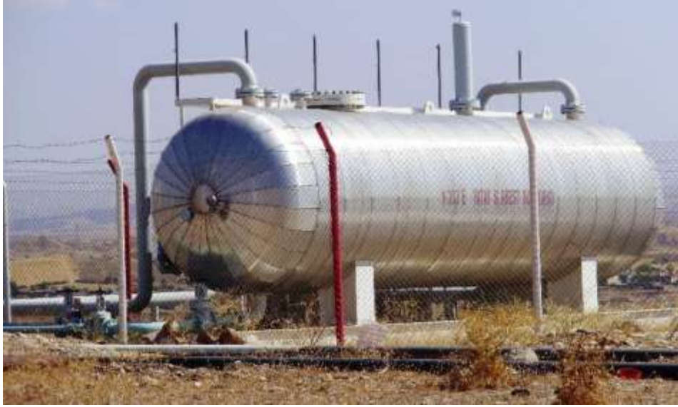
Fotoğraf 1: Su ve Ham Petrolün Birbirinden Ayrıldığı Serbest Su Ayırıcı Tankı
