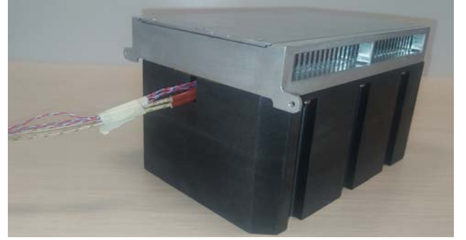
Şekil 7. Isıtıcı ile modülün montajlanmış hali (Assembled 3U Plug-In Module geometry with heater body)
