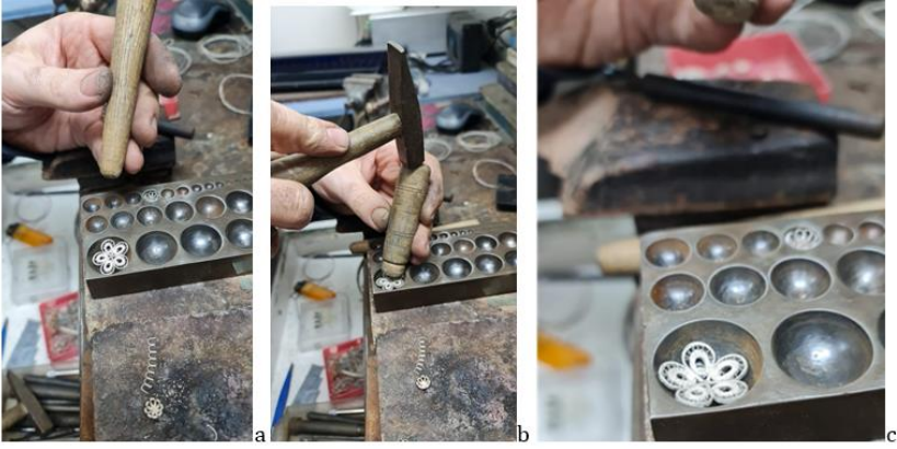
Fotoğraf 21a.b.c. Parçanın Şekillendirilmesi, Bombe Demiri, Zar Heşdek.
