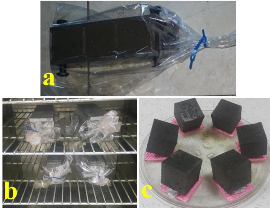
Şekil 3. Mikrodalga kürünün uygulama aşamaları (a) fırın torbasına sarılı taze harçlar, (b) etüv ön kürlenmesi ve (c) ön kürlenmesi tamamlanan harçların mikrodalga döner tablasına yerleşimleri
