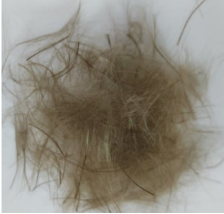
Şekil 3. Kompresörle ayrıştırılmış BF.
