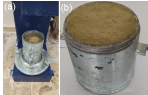
Şekil 5. Standart proktor deneyinin yapılışı (a) deney sonucu sıkıştırılmış örnek (b).
