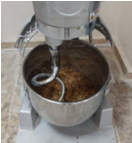
Şekil 4. Kil ve BF karışımlarının hazırlanması.
