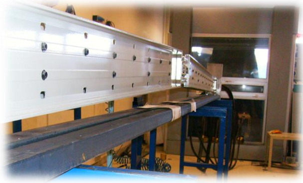
Şekil 3. Termal kuvvete maruz kalmış busbar
