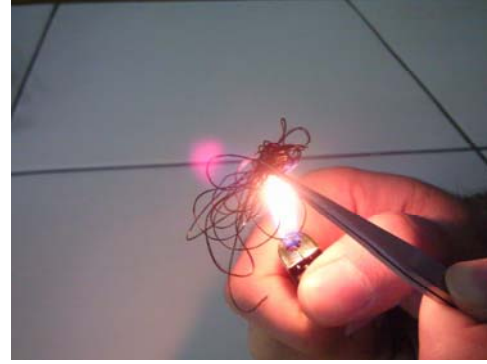
Şekil 4. 250°C’deki termal stabilizasyon numunesinin yanmazlık testi (Flammability test of thermal stabilization sample at 250°C)
