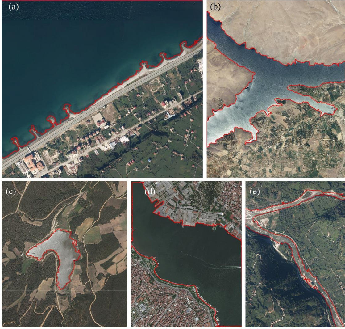
Şekil 9. Sınır düzeltme işlemi sonucu elde edilen su kütleleri sınırları. a) Çalışma alanı-1, b) Çalışma alanı-2, c) Çalışma alanı-3, d) Çalışma alanı-4 ve d) Çalışma alanı-1 akarsu.
