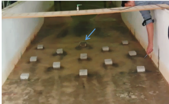
Şekil 8. Pürüzlü deneyde maksimum hidrolik sıçrama
