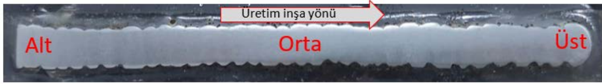
Şekil 5. Bakalit içine alınan mikroyapı numunesi
