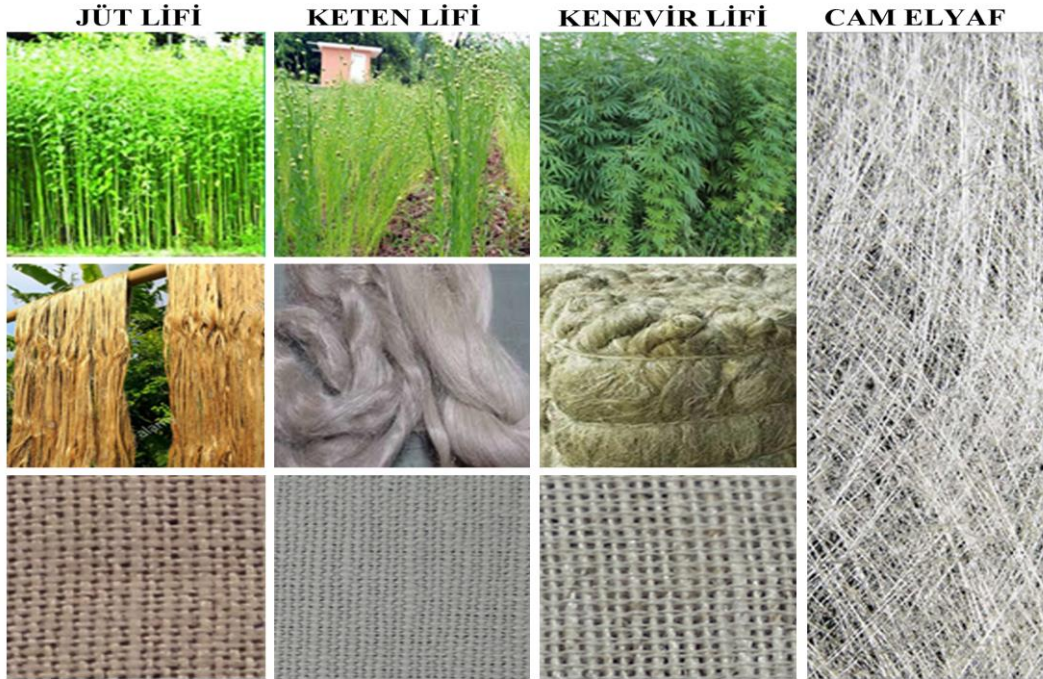
Şekil.2. Kullanılan doğal elyaf takviye elemanlarının işlem basamaklarına ait görünüm [URL-1].
