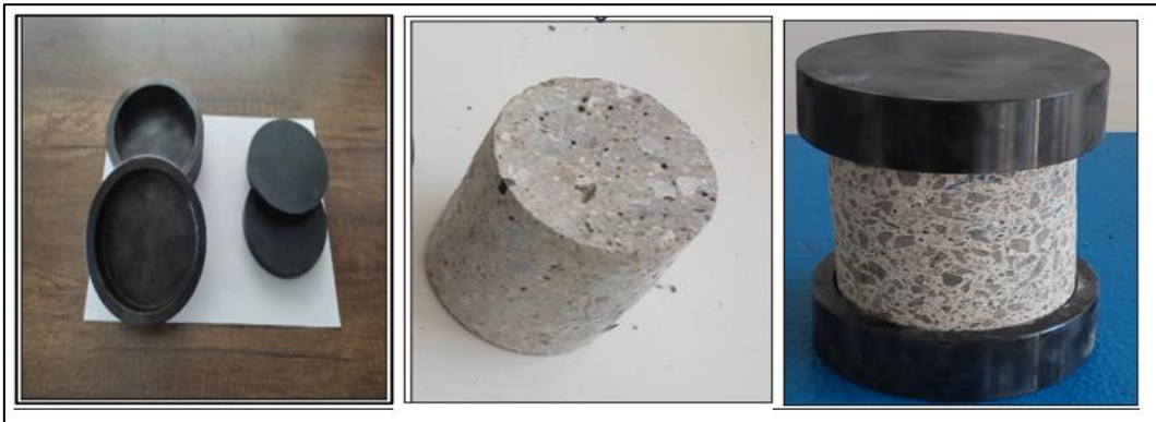
Şekil 3. Neopren başlık oluşturma aşamaları.
