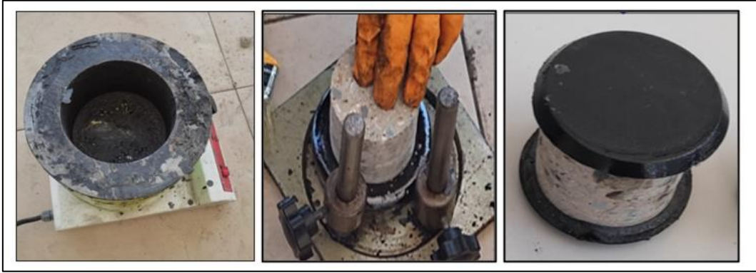
Şekil 4. Kükürt başlık oluşturma aşamaları.
