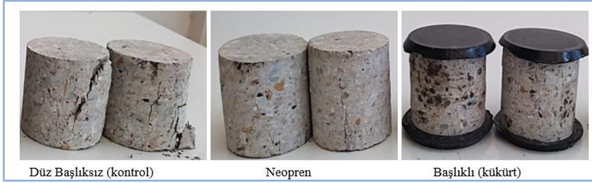
Şekil 8. Basınç dayanımı sonra numune görüntüleri.
