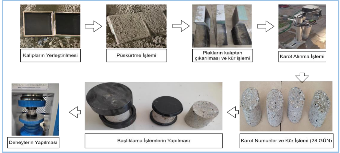
Şekil 5. Püskürtme beton üretim aşamalar Tablo 3. 1m 3 için karışım oranları (%)
