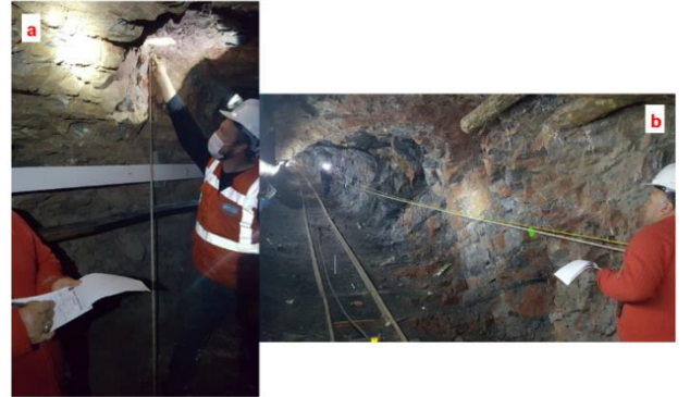
Şekil 6. Hat etüdü yöntemi ile ölçüm hattı boyunca süreksizlik aralığının tayini
