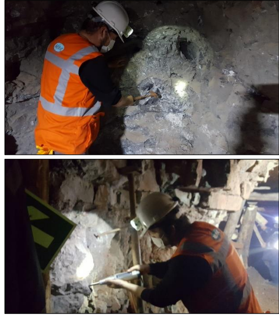
Şekil 9. a) Jeolog çekici yardımıyla kayaç dayanımının yerinde tespitine yönelik çalışmalar, b) Sağlam kaya ve eklem düzlemleri üzerinde Schmidt çekici ile yapılan ölçüm çalışmaları
