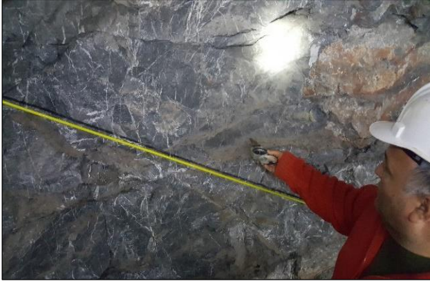
Şekil 10. Desandre ve galeride jeolog pusulası ile yapılan doğrultu, eğim ve eğim yönü ölçümleri.
