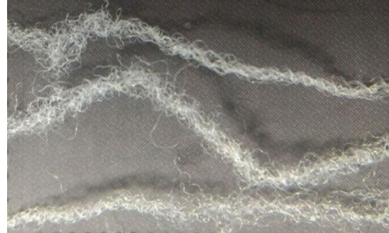
Şekil 3. Kesitinde 24 filament bulunan Ti katkılanmış PA 6 tekstürize iplik [24]
