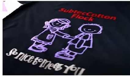
c: Kuru toz ve süblimasyon mürekkep kullanılarak yapılan baskı üzerine flok kağıdın transfer baskı yoluyla aktarılması
