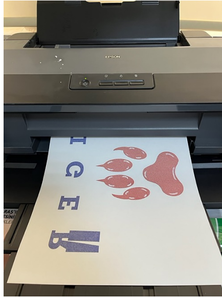
Şekil 11. Transfer baskı kağıdına sublimasyon mürekkep ile çıktı alınma işlemi
