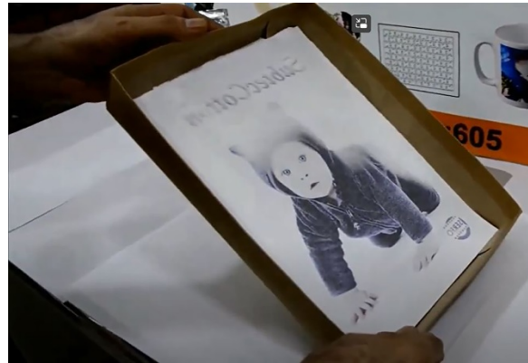
Şekil 5. Kuru tozun transfer kağıda uygulanması (Serfoto, 2023)
