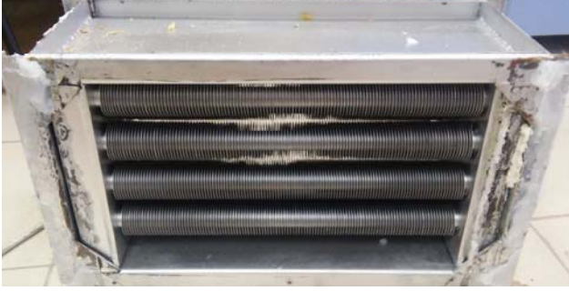
Şekil 2. L-ayaklı spiral kanatlı borulu ısı değiştiricisi fotoğrafı (Photo of L-footed spiral finned tube heat exchanger)
